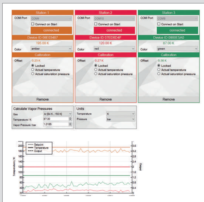
Рисунок 7 Программное обеспечение cryoTune отображает и записывает температуру в реальном времени и оставшееся время измерения с текущим уровнем заливки азота.
