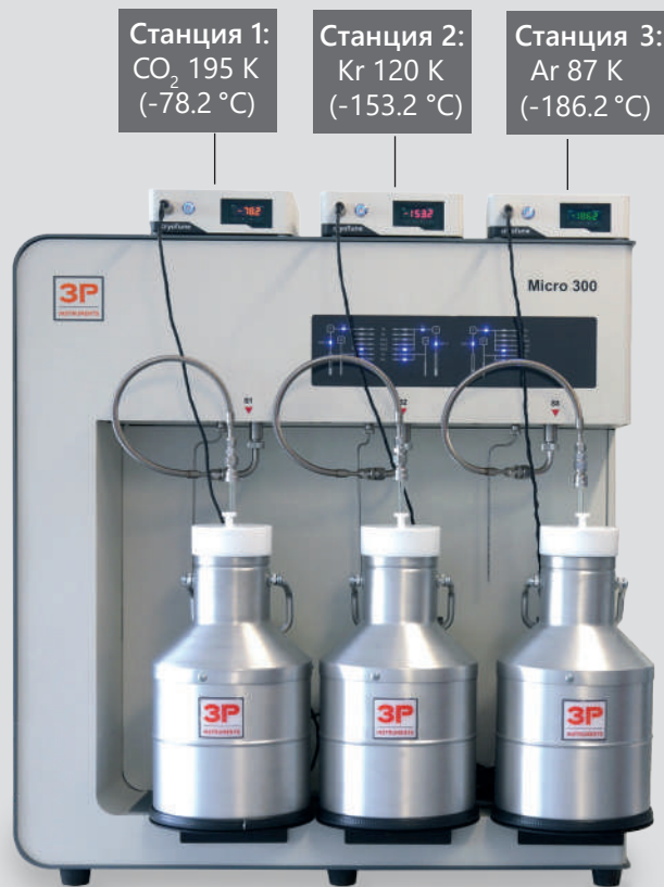
Рисунок 6 Три разных газа в трёх измерительных портах: приставки cryoTune 195, 120 и 87+ анализатор 3P micro
